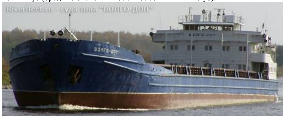
Рисунок 1 - Сухогрузный теплоход типа «Волго-Дон» .
