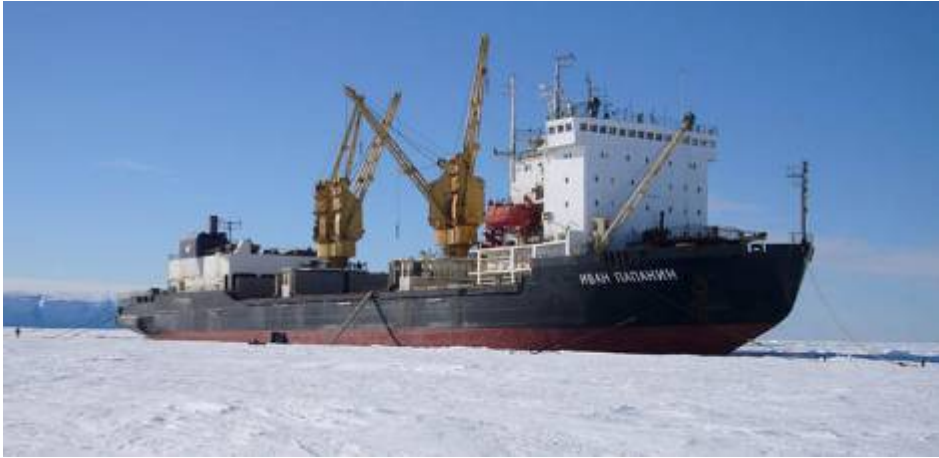
Рисунок 2 – Судно для генерального груза, с горизонтальной грузообработкой в кормовом трюме (Ro-Ro), дедвейт 10125 тон.
