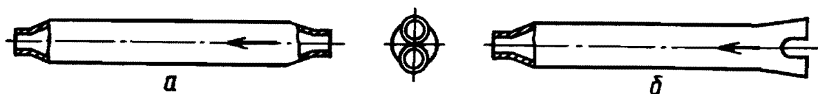
Рис. 78. Фильтр-осушитель с уплотняемым наполнителем и присоединением пайкой (VEB MAW Armaturenwerk, ГДР, Альтенбург):
