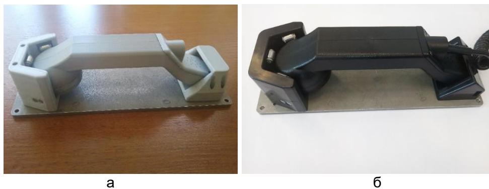
Рис. 1. Прототип телефонной трубки на основе технологии БП с держателем (а) и готовое изделие для серийного производства (б)
