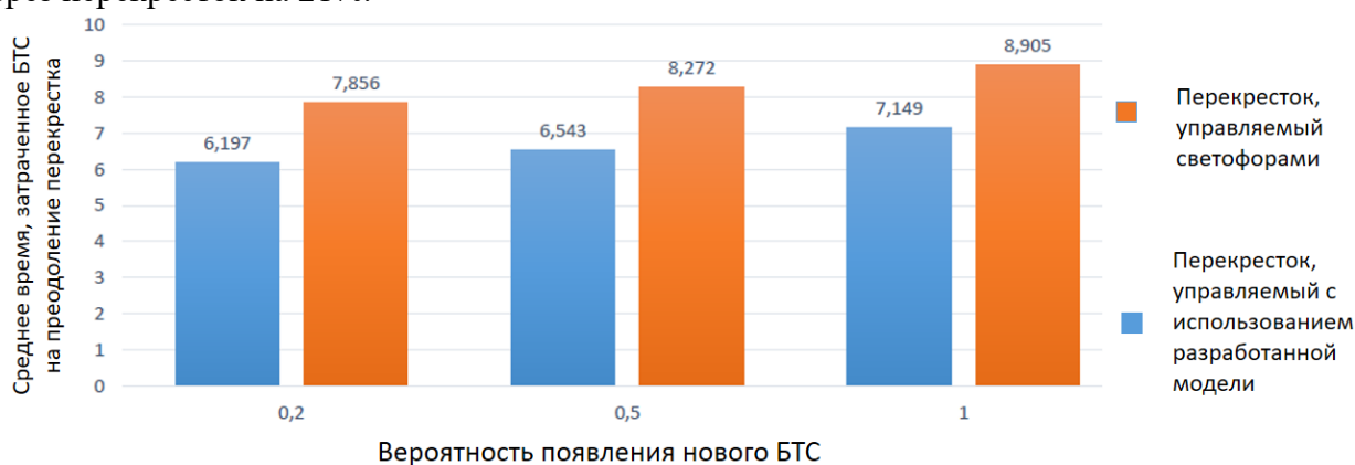
Рис. 2. Зависимость среднего времени, затраченного БТС на проезд перекрестка от вероятности появления нового БТС при разных схемах управления движением
