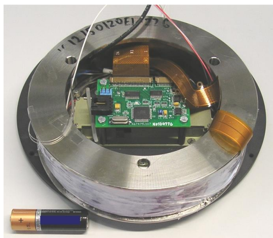
Рис. 1. Внешний вид опытного образца ВОГ (без наружного магнитного экрана)
