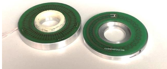
Рис. 1. Внешний вид ротора и статора преобразователя индукционного типа
