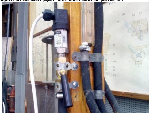
Рис. 5. Датчик давления для измерения уровня воды в U трубке
