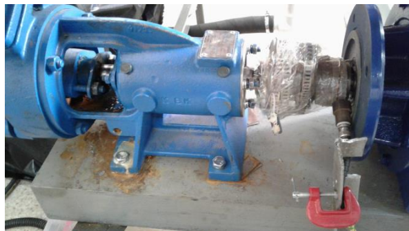
Рис. 4. Собранный система для измерения крутящего момента
