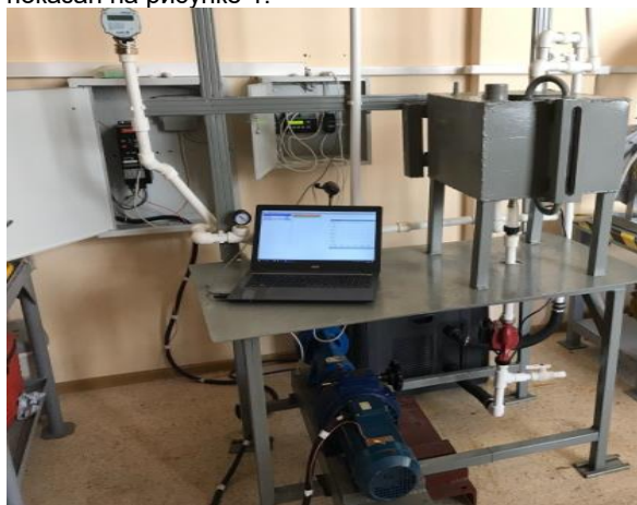
Рис. 1. Экспериментальный стенд для моделирования системы охлаждения судна забортной водой
