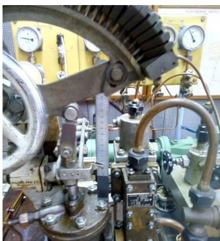
Рис. 4. Измерение перемещения штока сервомотора
